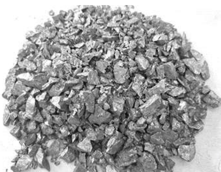
Foto 02 – Silício Metálico off grade .
